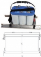
Verstellbares Ende für Batterie • Art.Nr.: 240144 • Material: Ed. Stahl • Breite: 170 mm • Univers. Halter f. Agm- oder Gel- Akkus • Mit einem Spanngurt • 165 cm lang, 25mm breit geliefert • - wird ohne Akkus geliefert - • ohne Abkantung
